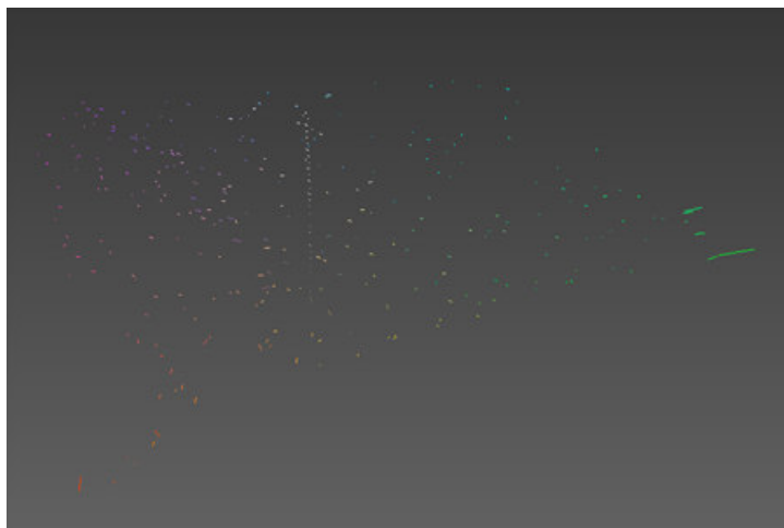
Plot 3D gli errori di verifica del comando profcheck, per il profilo ICC di tipo matrice ("independent gamma curves + matrix"). In alcune zone gli errori sono maggiori, come nella punta esterna dei verdi.
