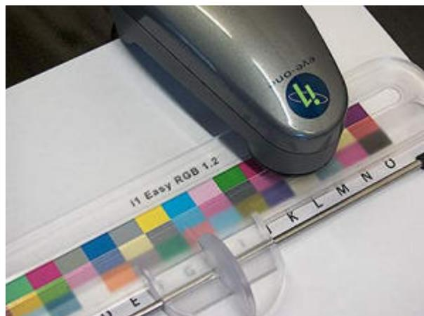
*Per profilare una combinazione stampante-inchiostro-carta, è necessario stampare un apposito foglio pieno di tacche colorate (chiamato "target") e successivamente misurarlo con l'apposito strumento con il relativo software di gestione. La misurazione può essere manuale o, se avete soldi da spendere, anche automatica mediante appositi meccanismi motorizzati: le tacche da misurare possono essere anche un migliaio!*
