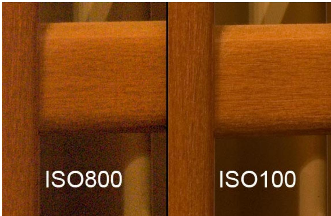
Le fotocamere reflex digitali, in virtú di un sensore di dimensioni rilevanti, hanno un rumore molto basso, che comincia a dar fastidio solo dalle sensibilita' ISO800/ISO1600 in su. Per la mia Minolta A1, col suo piccolo sensorino, già da ISO200 il rumore e' al limite dell'accettabile...
